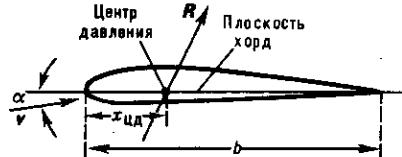
Положение центра давления потока на крыле:  $b$  — хорда;  $\alpha$  — угол атаки;  $v$  — скорость потока;  $x_{цд}$  — расстояние центра давления от передней точки тела.
