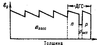
Рис. 3. Схематическое изображение изменения ширины запрещенной зоны МДГ в системе \text{Ga}_{1-x}\text{Al}_x\text{As} .
