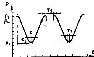
Рис. 1. Схема рабочих циклов пузырьковой камеры:  $\tau_1$  — задержка вспышки света на рост пузырьков;  $\tau_2$  — время между рабочими циклами;  $\tau_4$  — время расширения.
