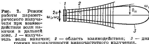
Рис. 2. Режим работы параметрического излучателя при взаимодействии волны накачки в дальней зоне. 1 — излучатель волны накачки; 2 — область взаимодействия; 3 — диаграмма направленности низкочастотного излучения.
