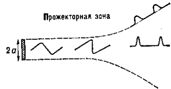
Рис. 4. Схема эволюции профиля волны в интенсивном УЗ-пучке.
