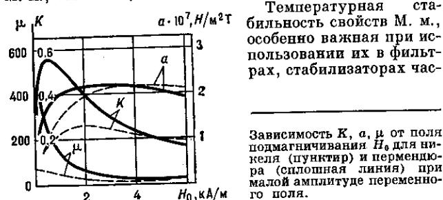
Зависимость  $K$ ,  $a$ ,  $\mu$  от поля подмагничивания  $H_0$  для никеля (пунктир) и пермандюра (сплошная линия) при малой амплитуде переменного поля.
