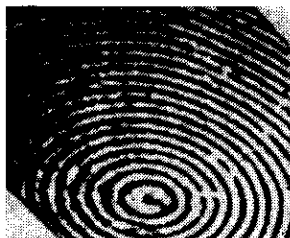
Рис. 10. Интерференционные полосы от винциального холмика на грани призмы кристалла ADP (рост из водного раствора).
