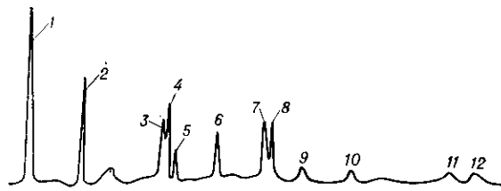
Рис. 1. Инфракрасный спектр излучения ртути. 1—12 — спектральные линии, длины волн которых в мкм равны: 1 — 1,014; 2 — 1,129; 3 — 1,357; 4 — 1,367; 5 — 1,395; 6 — 1,530; 7 — 1,692; 8 — 1,707 и 1,711; 9 — 1,814; 10 — 1,970; 11 — 2,249; 12 — 2,326.
