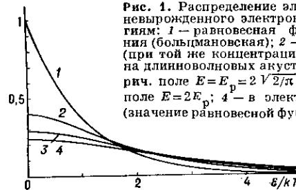
Рис. 1. Распределение электронов (в случае невырожденного электронного газа) по энергиям: 1 — равновесная функция распределения (Больцманова); 2 — распределение Г. э. (при той же концентрации) при рассеянии их на длинноволновых акустич. фононах в электрич. поле  $E = E_p = 2V2/\pi s/\mu$ ; 3 — в электрич. поле  $E = 2E_p$ ; 4 — в электрич. поле  $E = 3E_p$  (значение равновесной функции распределения при  $\mathcal{E}/kT = 0$  принято равным 1).
